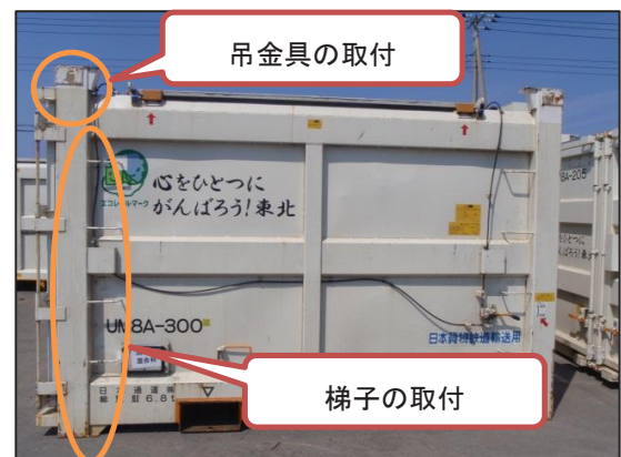
図6-10 災害廃棄物用コンテナ改造概要
