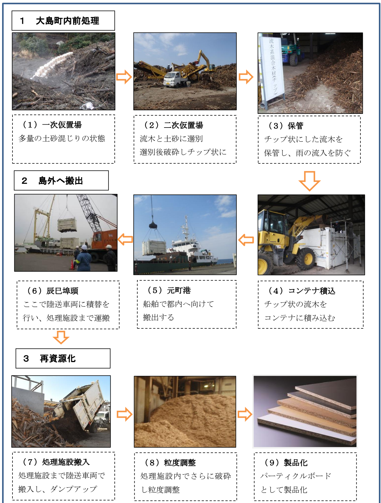
図 6-16 大島町災害廃棄物の前処理及び廃木材の再資源化フロー
