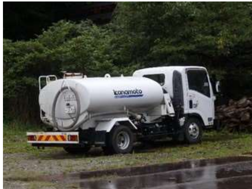
散水車 土砂を洗い流すためにも利用
