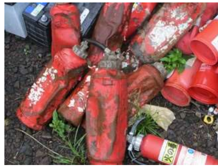
つぶれた消火器
