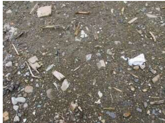
木片・プラ片が混じるが埋立条件に合うよう徹底したふるい作業により埋立整備事業で使用
