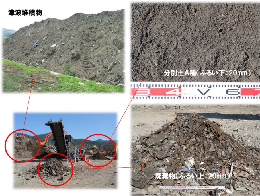
図 5-2 津波堆積物のふるい選別(乾式分級)の例
