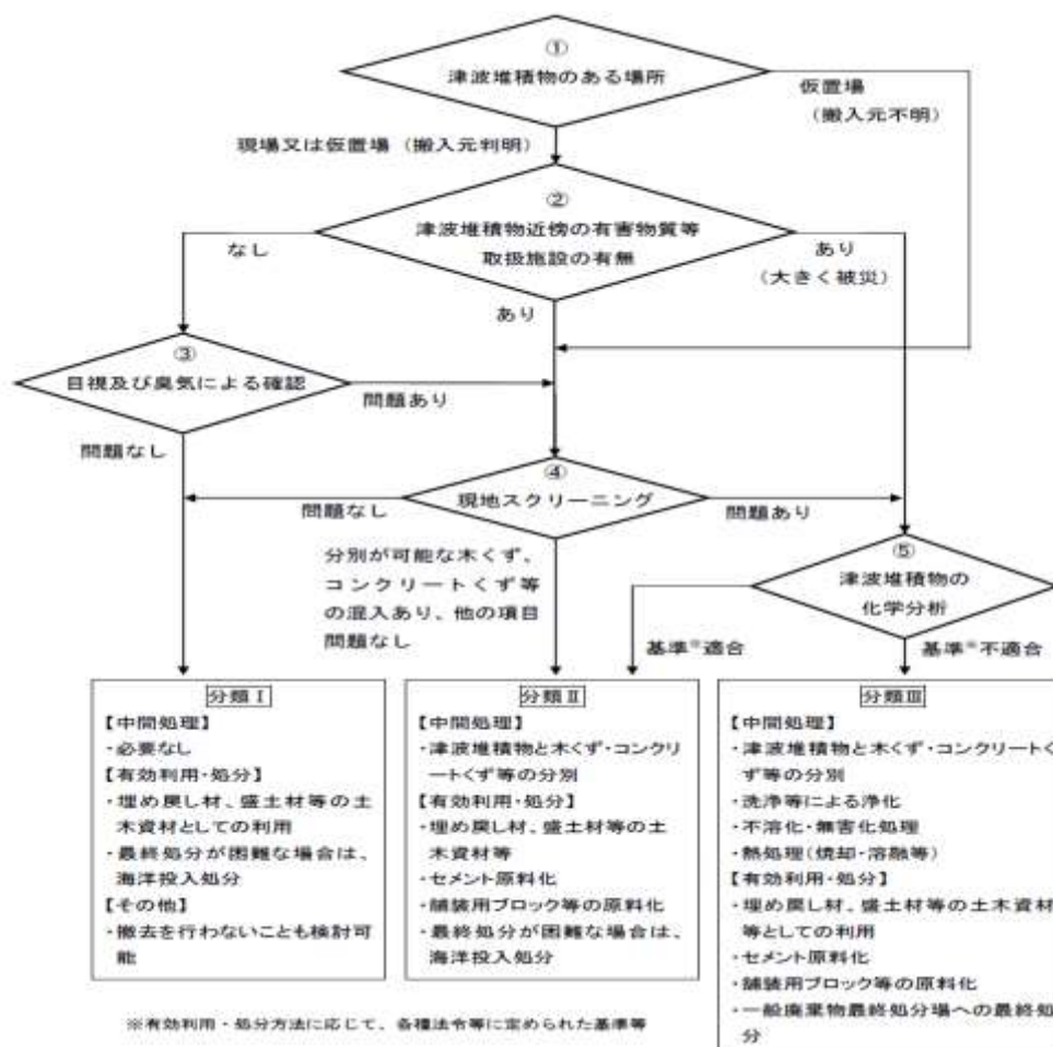
図2-3-12-1 津波堆積物の基本的処理フローチャート
