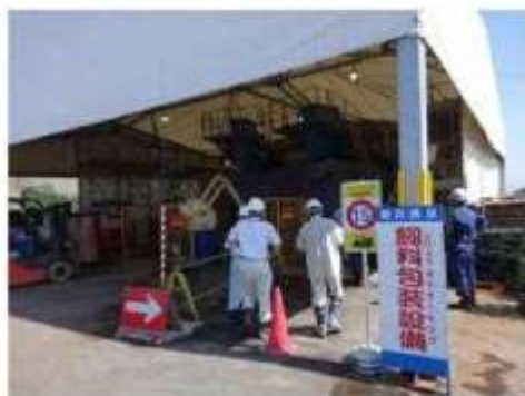
飼料梱包設備（石巻ブロック） 日処理量：約 65t/日（約 4,300 袋/日、 25 リットル/袋 飼料比重 0.6 t/m 3 ）
