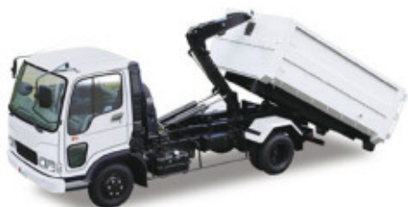
脱着装置付コンテナ自動車
