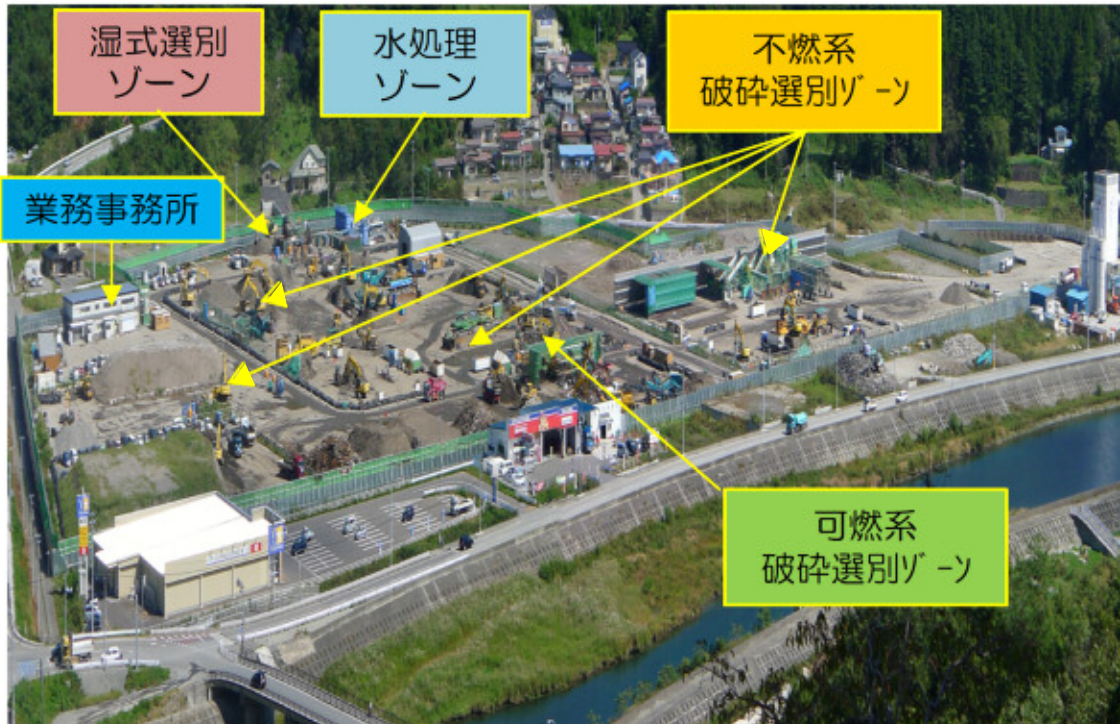
図 2-6-2 二次仮置場施設配置計画例
