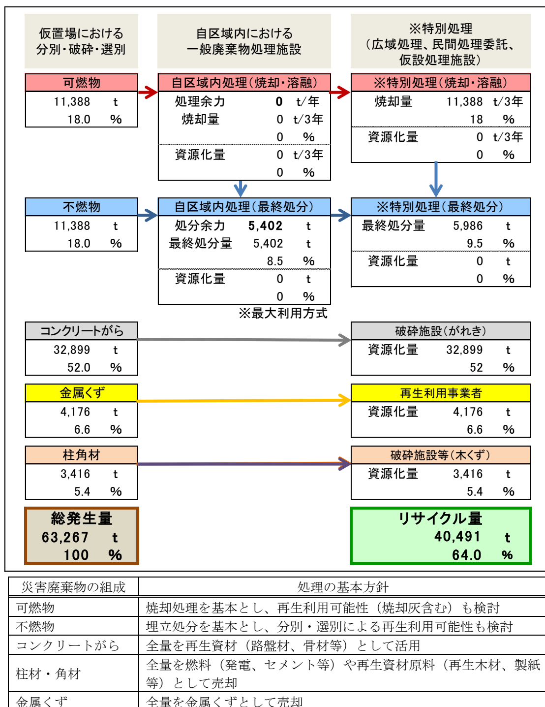
図 1-17 本市における災害廃棄物の基本処理フロー案と処理の基本方針
